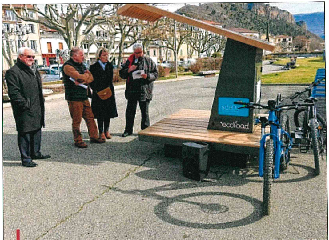
La borne utilise des panneaux photovoltaïques et permet de recharger, avec ses batteries Bosch et Yamaha, un vélo en 30 à 40 minutes.
